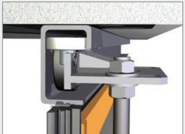
Laufschienenprofil - in Laibung
