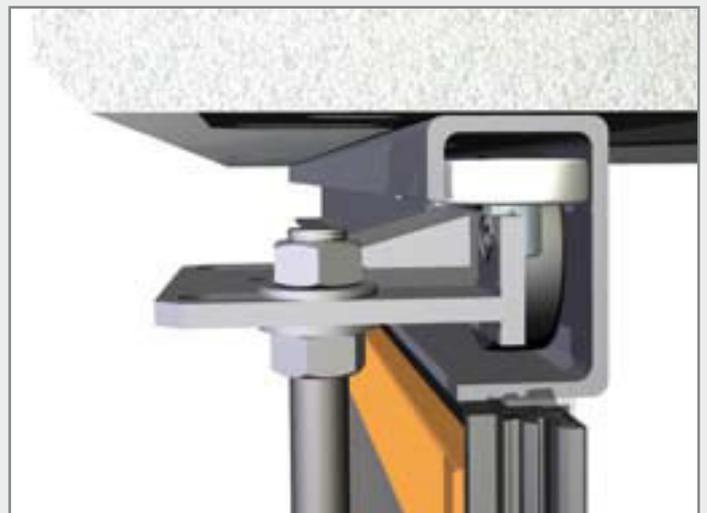
Laufschienenprofil - in Laibung
