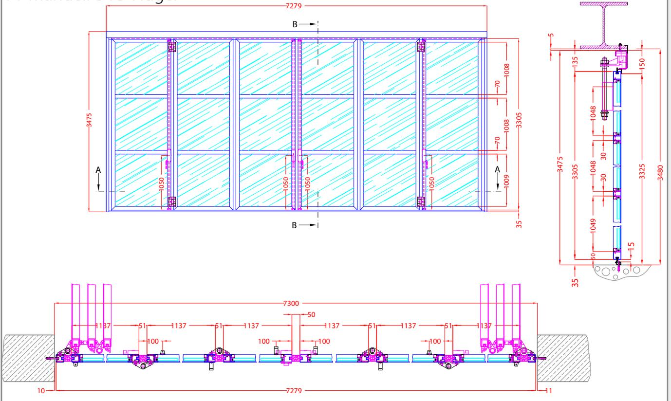
FT austragend manuell 2+3 Flügel mit Gehrür im Torflügel
